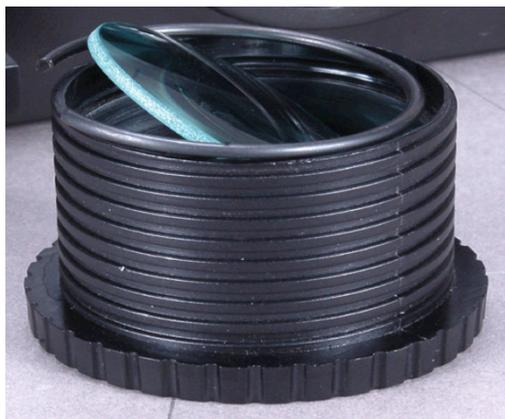
Retournez le tube et insérez la lentille. Insérez gentilement l'anneau de fixation. Soyez vraiment prudent en vérifiant que l'anneau se maintient parfaitement contre la lentille. Maintenant vous pouvez revisser le tube du focus sur le H2O IR
